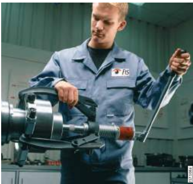
Рисунок 1 Демонтаж подшипника с помощью гидравлического съемника
