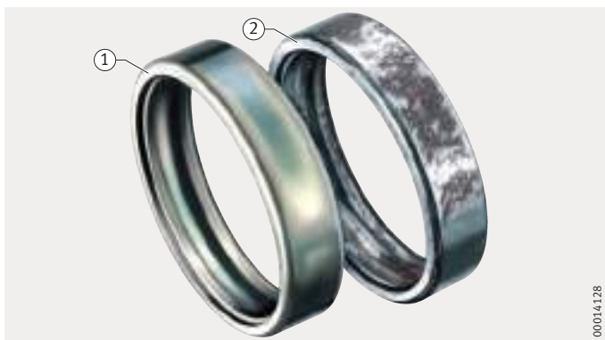
Рисунок 11 Кольца подшипников после испытания в солевом тумане
