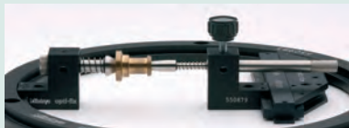
Удерживает цилиндрическую деталь между крепежными наконечниками.
