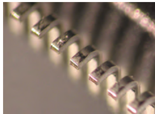
Пример измерения : высота пиков на QFP-корпусе
