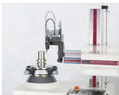
Измерение/анализ по спирали (RA-1600)
