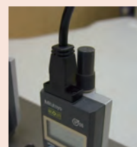
Индикатор ID-N ABS Digimatic с кабелем 02AZD790G
