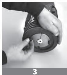
● Fori di smontaggio / Removal holes / Abdrückbohrungen / Trous d'extraction / Agujeros de desmontaje
