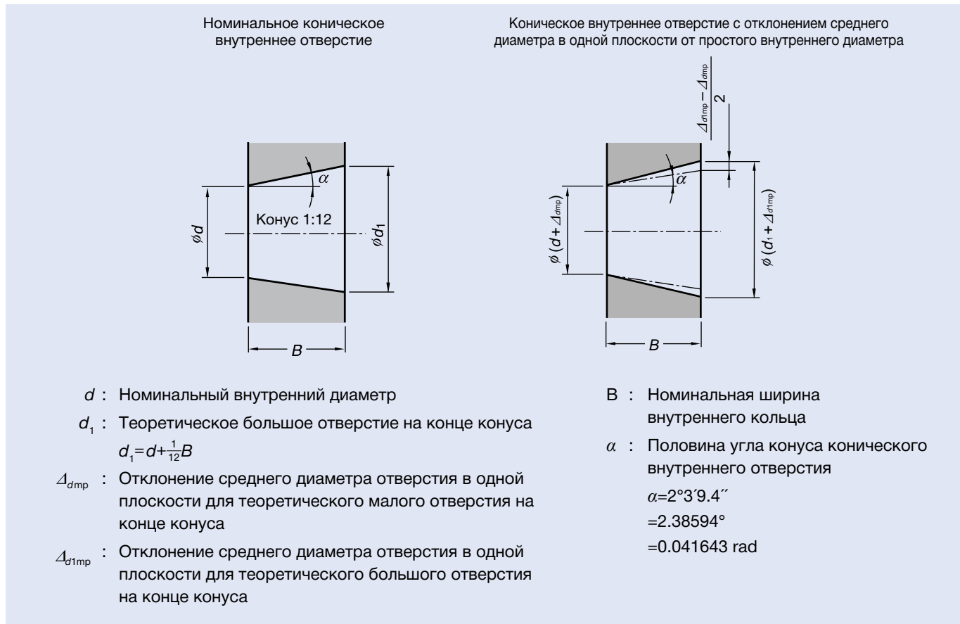
Рис. 7.3 Допустимые отклонения конического внутреннего отверстия
