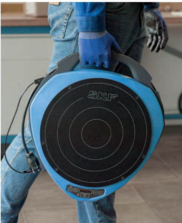
TWIM 15 работает от электросети. Конструкция из высокотемпературного пластика, армированного стекловолокном, обеспечивает низкую разницу температур между внутренним и наружным кольцами подшипника. Это позволяет уменьшить внутренние напряжения, возникающие вследствие чрезмерного температурного расширения внутреннего кольца относительно наружного.
