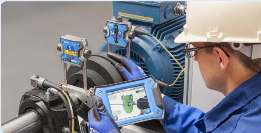
Выверка соосности валов значительно повышает эксплуатационную готовность оборудования и снижает расходы на техобслуживание, поэтому рекомендуется практически в любой отрасли. Простота TKSA 41 позволяет выполнять процедуры выверки на любых горизонтальных узлах вращения.
