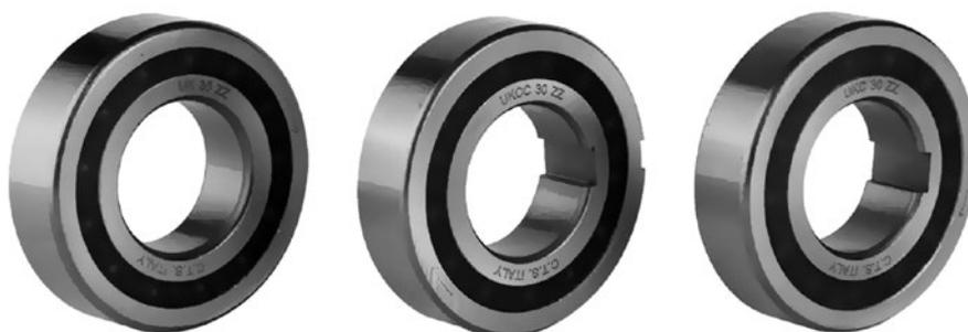
Обгонные муфты серии UK..ZZ соответствуют по размерам подшипникам 62 серии. Это самоцентрирующиеся обгонные муфты, смазанные на весь срок службы и снабжены пылезащитными щитками.
