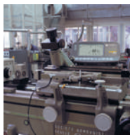
Application: TT 80 with a SIP (Société genevoise d'instruments de physique) high precision measuring bench
